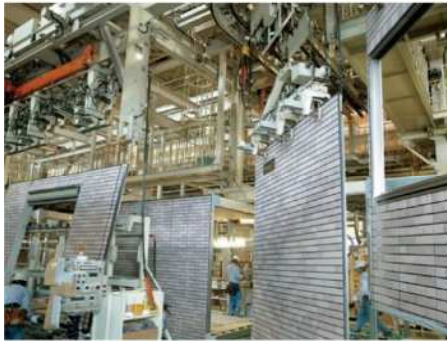
重く大きな部材も 大型機械で正確に組み立て
