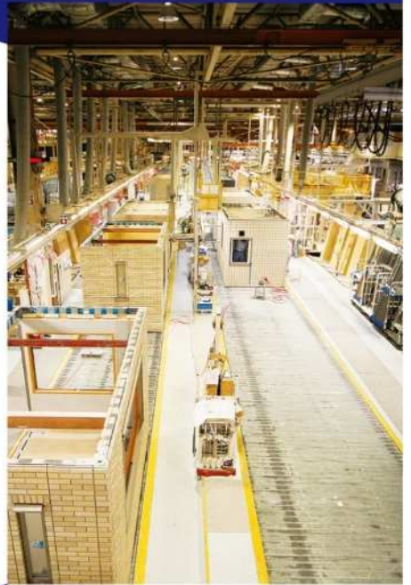
屋根の下での施工で 風雨による劣化を防ぐ
